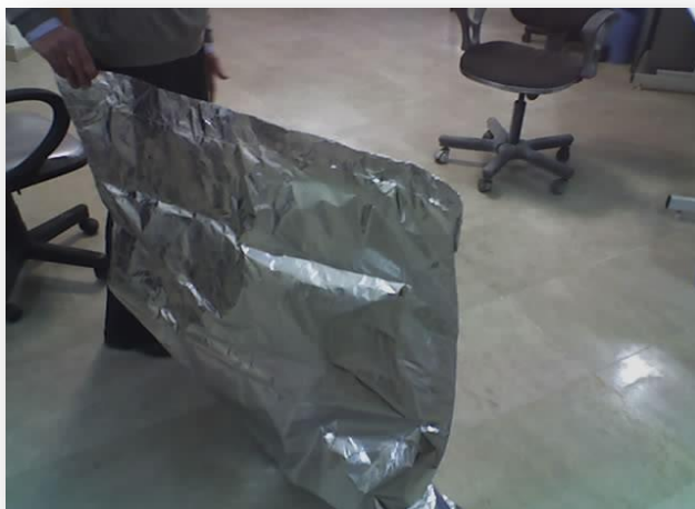
یک نمونه محفظه طراحی و ساخته شده از جنس آلومینیوم با ضخامت حدود ۱ تا ۱.۵ میلی متر برای حفاظت تجهیزات حساس
